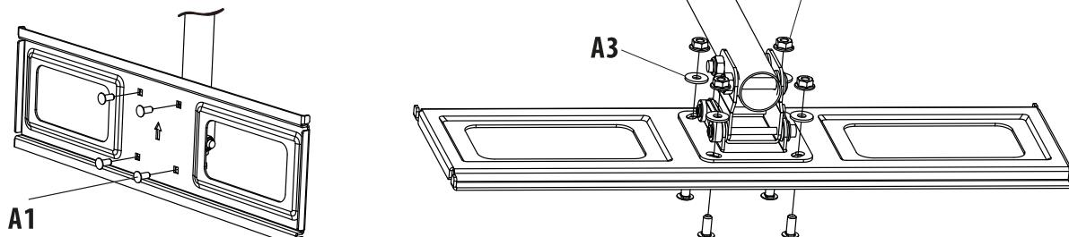
**CZ:** Namontujte kolej (**M3**) na opěrnou tyč (**M2**) pomocí 4 šroubů (**A1**), podložek (**A2**) a matic (**A3**). Dbejte na to aby šipka na přední straně směrovala nahoru ve směru opěrné tyci.
