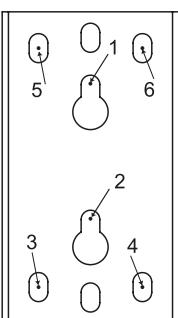
**CZ:** Po výbere vhodného nosného bodu na připevnění konzoly položte komponenta (**M1**) na strop a pomocí pera vyberte nejméně 6 upevňovacích bodů. Doporučujeme zvolit 3-3 body na každé straně.
