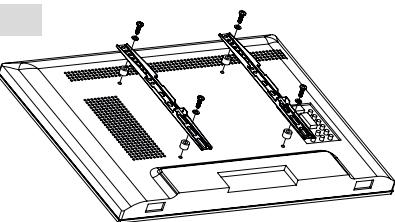
**CZ:** Na zadní stranu TV nebo monitoru namontujte opěrnou kolej (M4) s VESA standardem. V případě potřeby použijte rozpornou šroub (G) mezi zadní stěnou TV a kolejí. Během připevnění kolej použijte vhodné šrouby (D / E) a podložky (J) k televizoru.
