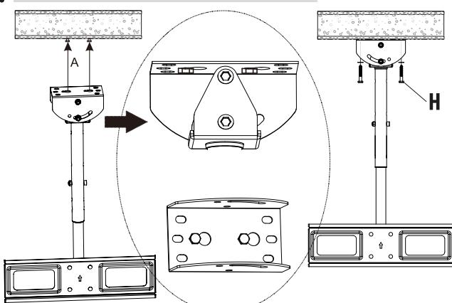
**CZ:** V zájem správného připevnění utáhněte všechny šrouby. Po kontrole všech šroubů, přiložte konzolu (**M1**) k 6 vyvrťaným díram a upevněte ji pomocí šroubů s označením (**H**). V případě potřeby použijte podložky.
