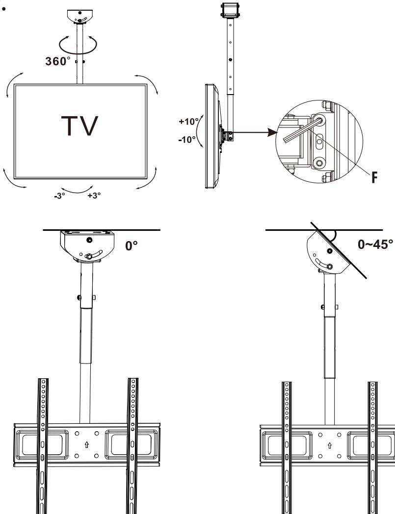
**CZ:** Úhel televizoru můžete upravit uvolněním a připevněním dvou imbusových šroubů na zadní straně. Po správném namontovaní lze zařízení otočit o 360°. Výrobce a distributor neodpovídají za žádné škody způsobené nesprávnou a správnou montáží.
