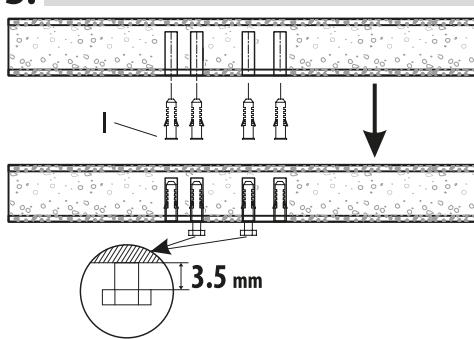
**CZ:** Do dvou středních hmoždinek se pokuste vložit šrouby M8 x 60 s označením (**H**). Mezi rovinou stěny a hlavou skrutky může být maximální vzdálenost 3,5 mm abyste dosáhli vhodné upevnění.
