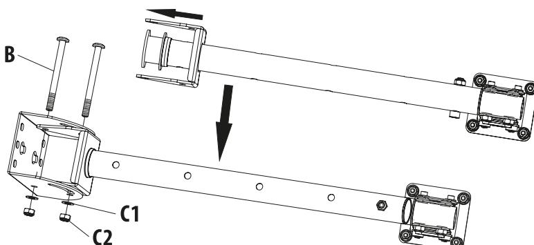
**CZ:** Hlavu konzoly (**M1**) a tyč (**M2**) smontujte spolu se dvěma M8 x 95 hřidelemi (**B**). K připevnění hřidele používejte podložku (**C1**) a matici (**C2**) kterou naleznete v sáčku.Jeden hřidel umístěte tak aby byl volna nastavitelný do 45 stupňového úhlu a k druhému použijte díru umiestnenu na stredu.
