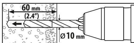
**CZ:** Vyvrtejte 6 dier podle značení a vložte do nich hmoždinky (10 x 50) s označením (**I**). K tomuto procesu použít vrták s rozmerom 10, vrt musí být hluboký 60 mm!
