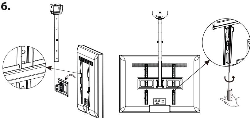
**CZ:** Pokud jste zkontrolovali zda jsou kolej a konzola správně připevněné ke stropu, poprose někoho o pomoc k umístění a zavěšení televizoru. Připevnit jej můžete pomocí dvou hvězdicových šroubů na spodní části konzoly.
